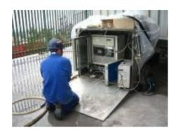
\*Este servicio puede incluir el análisis de los gases de combustión de varios componentes, incluyendo  ${\rm O_2}$ , CO,  ${\rm CO_2}$ , NOx, SOx
