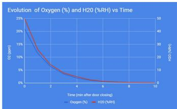
En menos de 5 minutos se obtiene un contenido de humedad <1% en el interior del armario.
