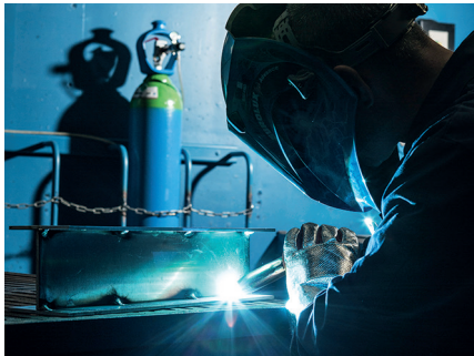
Soldadura MIG de aluminio
