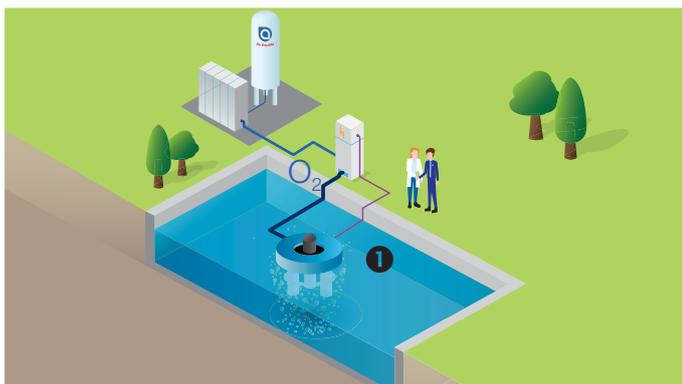
Ambos sistemas se instalan con rapidez y facilidad. Los armarios de control eléctrico y de regulación de gas se colocan cerca de los reactores para facilitar su manejo. La aplicación de oxígeno se puede optimizar mediante un sensor de oxígeno disuelto y una regulación todo/nada o proporcional.
