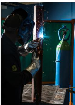
*ARCAL™ Chrome, la mezcla argón/CO<sub>2</sub> de referencia para la soldadura MAG de aceros inoxidables con poder oxidante controlado.*
